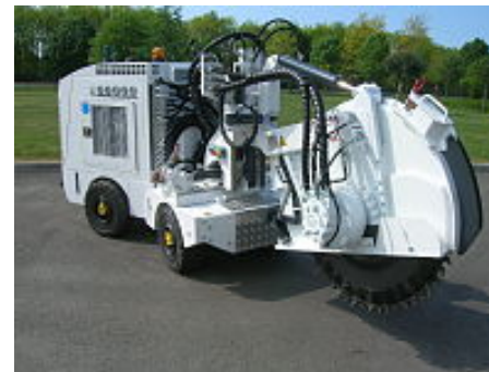
Beispiel für Fräsmaschine zum Micro-Trenching
